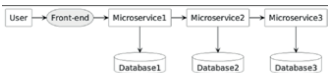
Рис. 1. Современная микросервисная архитектура веб-приложения
